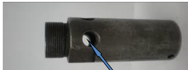
Пересечение отверстий разного диаметра
