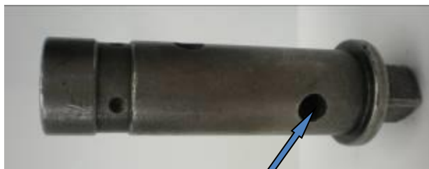
Коническая засверловка
